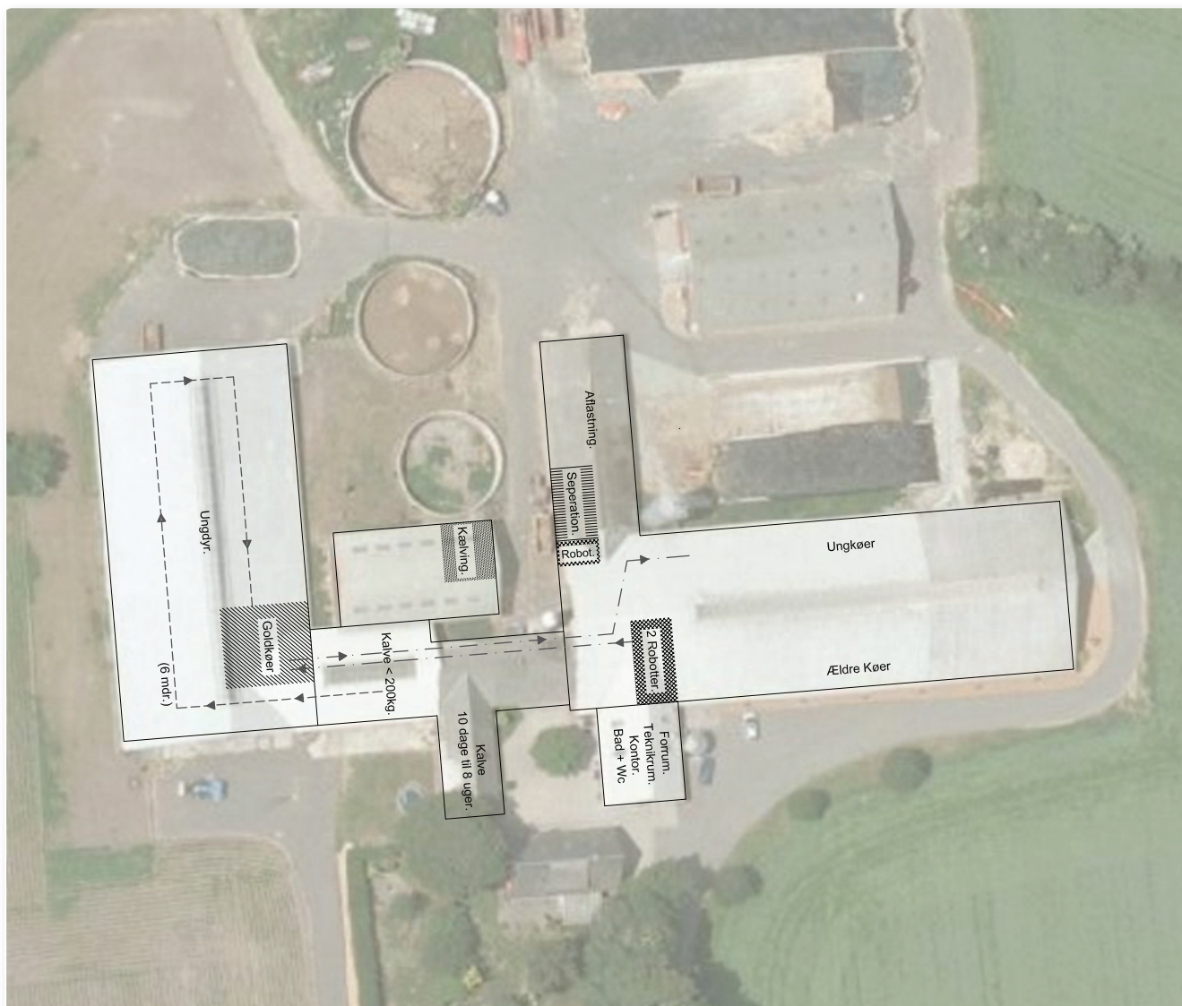
Figur 8. Diagram over drivgange. Diagrammet er benyttet i planlægningsfasen, hvor man ønskede logistisk at arbejde med transporten med det mål at opnå større effektivitet. På diagrammet er udelukkende indtegnet fodertransporten (pilene illustrerer fodertransporten), men kunne nemt suppleres med de andre eksisterende transportter og dermed illustrere områder, hvor der er risiko for ulykker.
